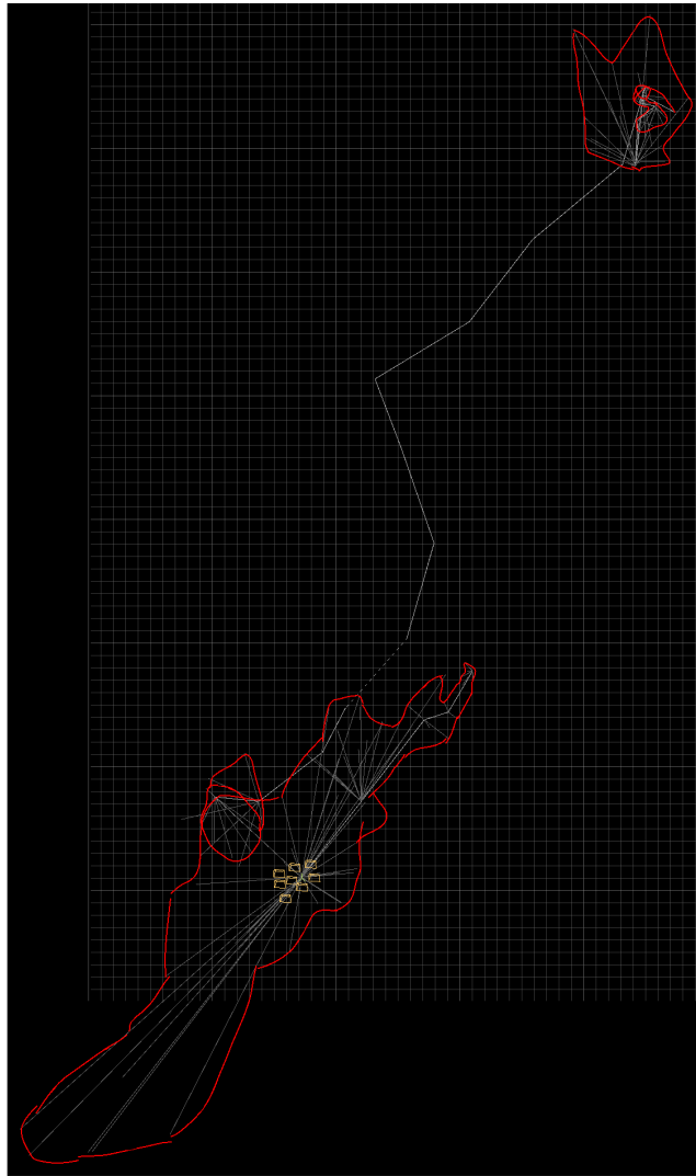
Topographie des 2 avens en plan obtenue en temps réel (Topodroid + Disto X)
