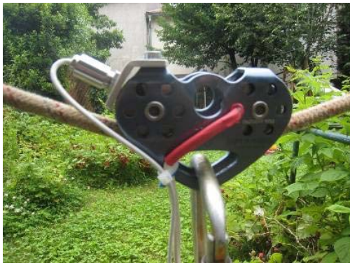
Les deux poulies instrumentées utilisées lors des tests
