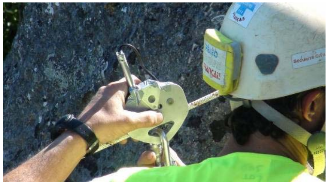
Les deux poulies instrumentées utilisées lors des tests
