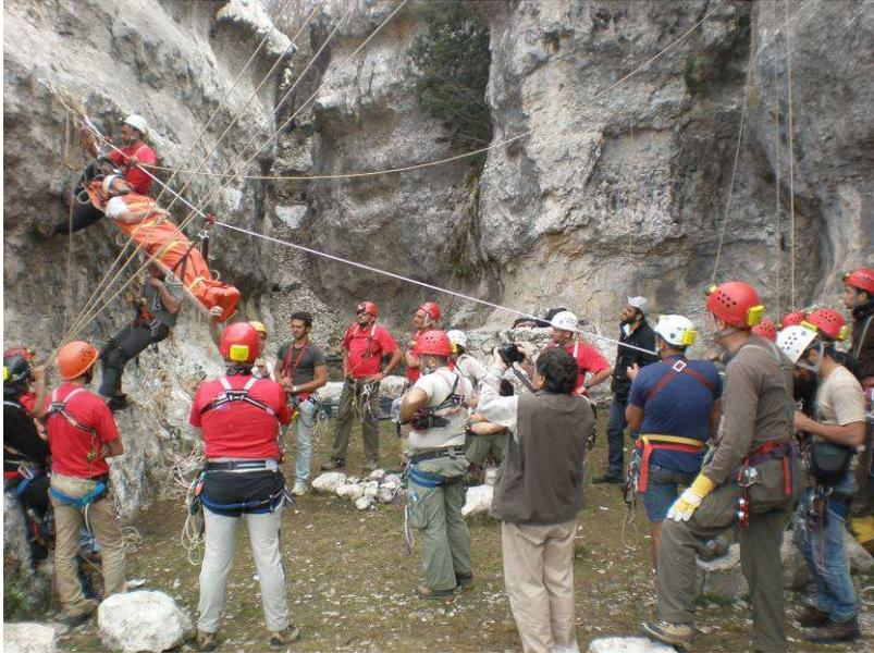
Pour les palans nous avons fait des tests comparatifs en changeant le dispositif en tête d'atelier et mesurer le rendement : Avec le pro traxion ou le mini traxion on dépasse les 35%, avec une rescue on approche des 30% alors qu'avec une poulie bloqueur on passe en dessous des 25%.
