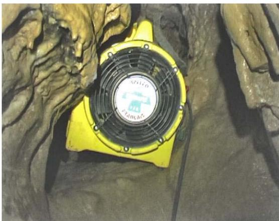
Le ventilateur utilisé a un débit nominal de 1400 m<sup>3</sup>/h. Son alimentation sur accumulateur 12 v permet de ventiler la zone de tir loin de l'entrée, là où il n'est pas possible de dérouler un câble électrique par exemple.
